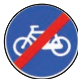
Fin de vía reservada para ciclos
