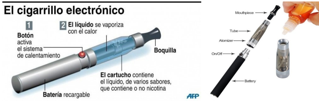
Figura 1. El cigarrillo electrónico y sus componentes
