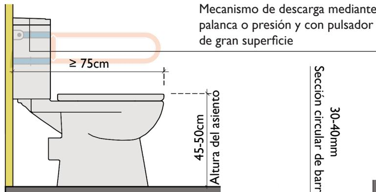
Mecanismo de descarga mediante palanca o presión y con pulsador de gran superficie
